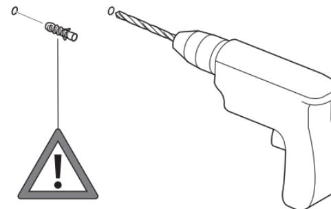
**Fig.1E NOTA BENE:** Scegliere i tasselli ad espansione idonei per la superficie destinata al montaggio.
