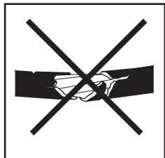
**ITA.** Il cavo flessibile esterno di questo apparecchio non può essere sostituito; se il cavo è danneggiato, l'apparecchio deve essere sostituito.
