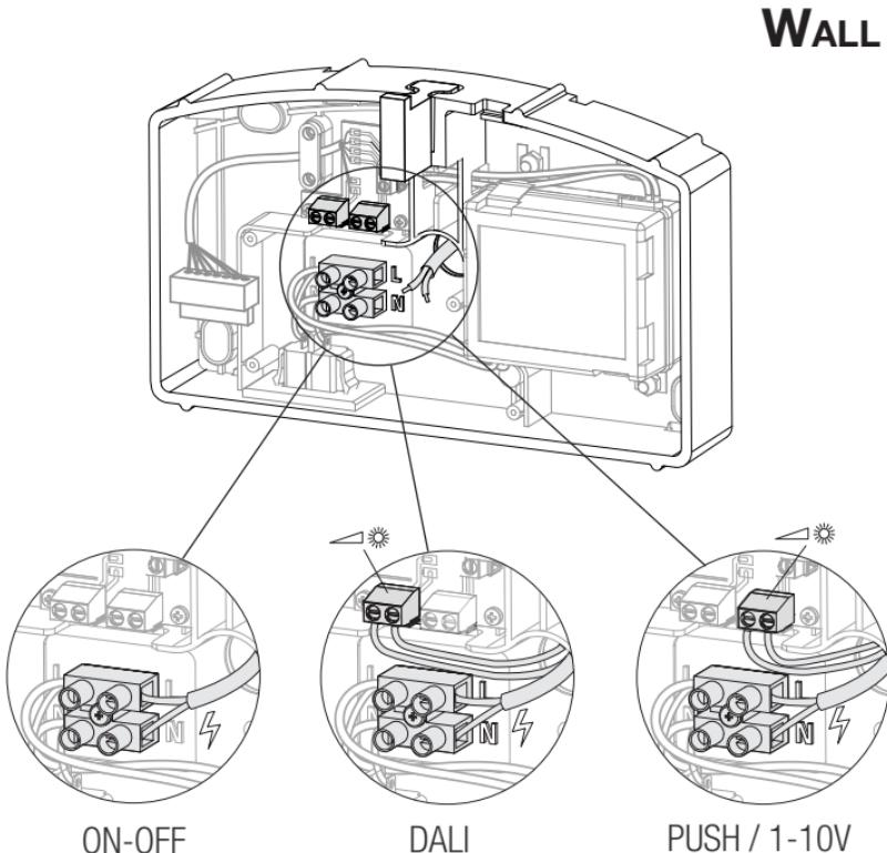
J 図5. 接続方法：1 - ON-OFF: 点灯と消灯、そして器具に設置された光学センサーを用いた照明調節—図.14; 2参照 - DALI: 点灯と消灯、そしてDALIシステムを用いた照明調節—器具に設置された光学センサーは作動したままです。（センサーを作動停止させるには図14参照）；3 - PUSH/1-10V: 点灯と消灯、そしてノーマルオープンボタンもしくは"Dimmer 1-10V (Current Sinking)"を用いた照明調節；A) ノーマルオープンスイッチ使用、器具に設置された光学センサーは作動したままです。（センサーを作動停止させるには図14参照）；B) "Dimmer 1-10V"使用、光学センサーは自動的に作動停止します（led消灯）、1Vをオーバーするシグナルの最初の使用から20秒後に、光学センサーは自動的に無効になります（光学センサーを再び作動させるには図14参照）。
