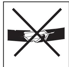
**IT.** Il cavo flessibile esterno di questo apparecchio non può essere sostituito; se il cavo è danneggiato, l'apparecchio deve essere sostituito.
